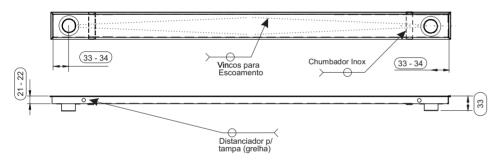
Obs.: as calhas acima de 1000 mm apresentam duas saídas para garantir a capacidade de vazão.
